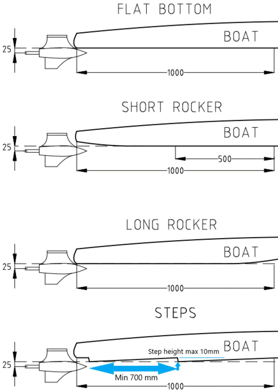
**HYDROPLANE AND OSY400 PROPELLER SHAFT HEIGHT MEASUREMENTS**
